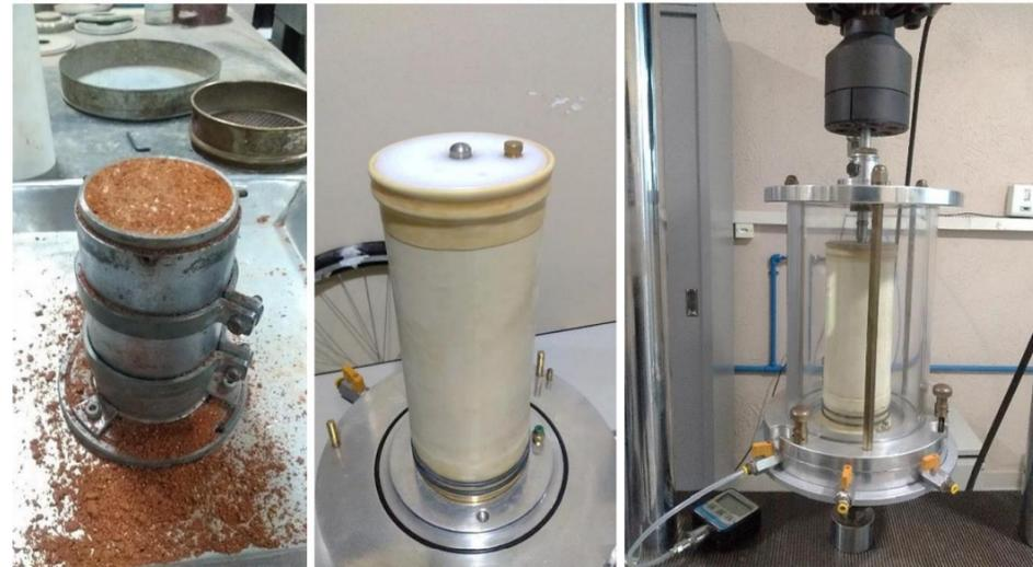
Figura 56 – Ensaio de deformação permanente
