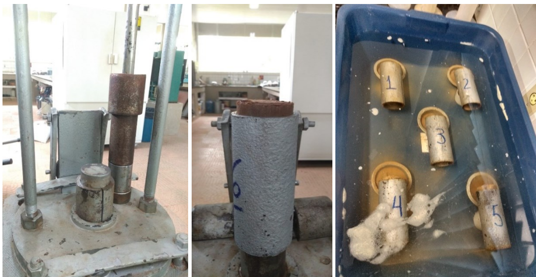
Figura 55: Ensaio para classificação MCT e G-MCT
