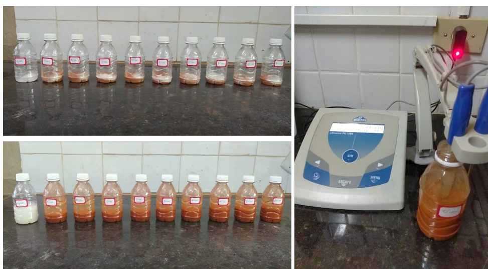
Figura 71: Dosagem do teor mínimo de cal
