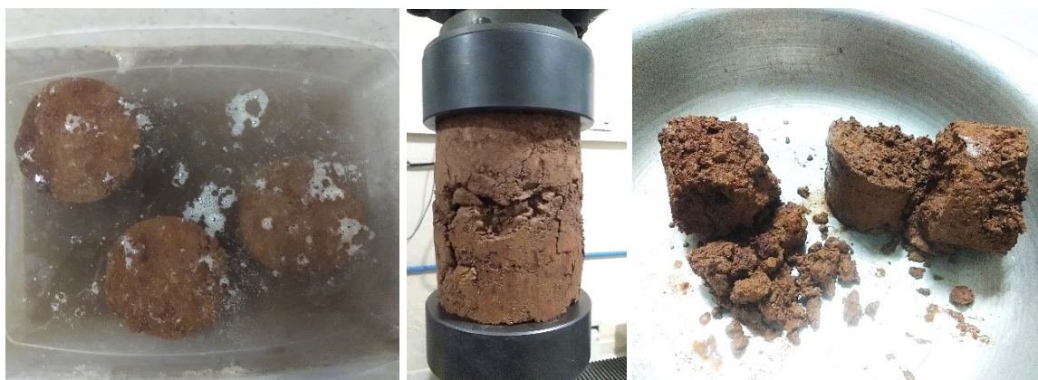
Figura 169: RCS do SLP (PB-3) com 1% de cimento
