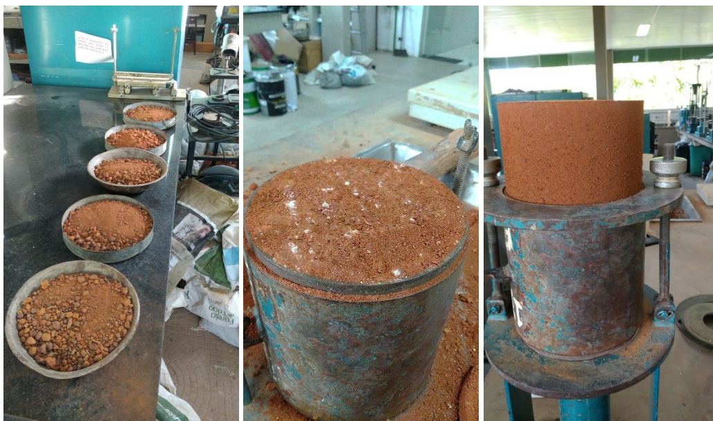
Figura 53: Ensaio de compactação
