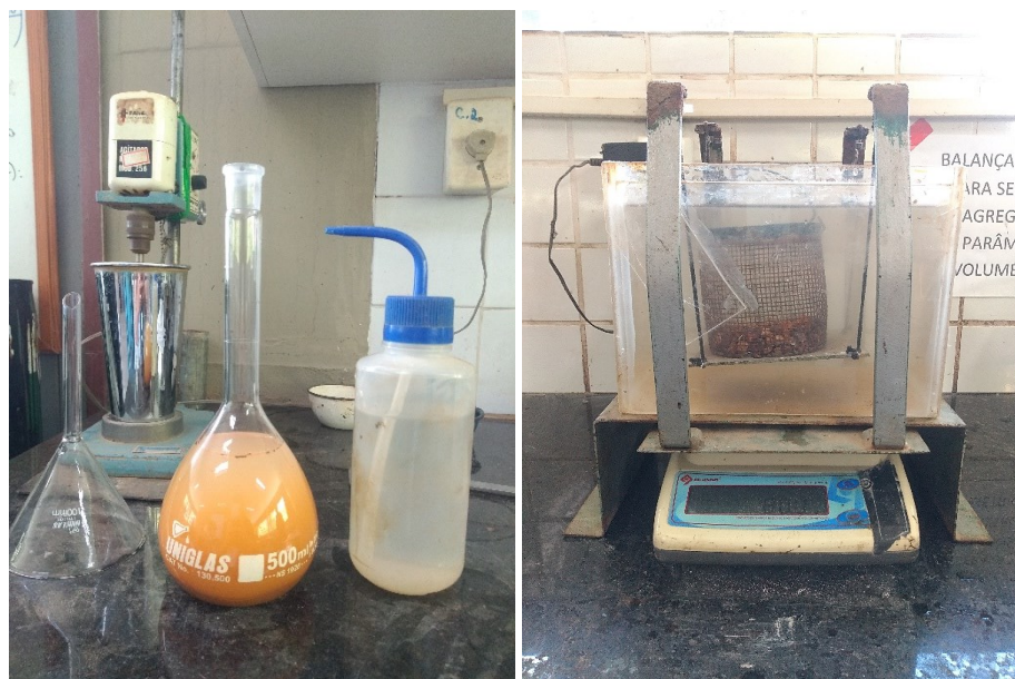
Figura 42: Densidade real dos grãos
