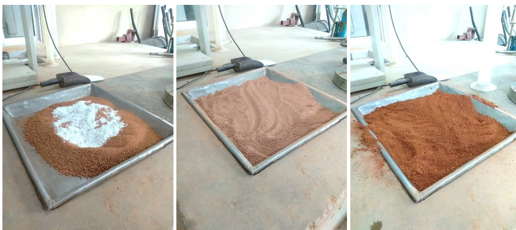
Figura 170: Mistura e homogeneização do solo, estabilizante e água
