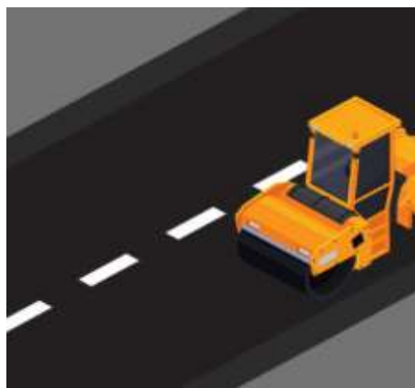
Figura S105 - Regularização da superfície de rolamento
