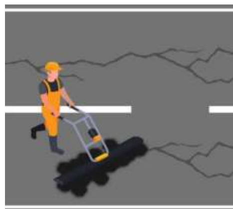
Figura T27 - Aplicação de emulsão asfáltica
