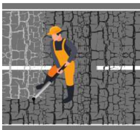
Figura T9 - Selagem das trincas com lama asfáltica
