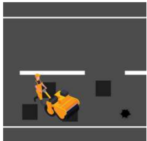
Figura P69 - Preenchimento da painela com pré-misturado a frio
